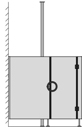
Les larges sections frontales peuvent être stabilisées par un tube en aluminium qui s'étend jusqu'au plafond.
