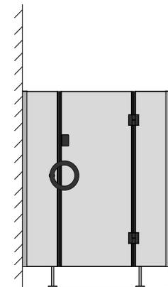
Si nécessaire, une serrure de porte peut être installée. Elle est disposée de manière à ce que le personnel puisse passer la main par-dessus la porte pour la déverrouiller en cas d'urgence.
