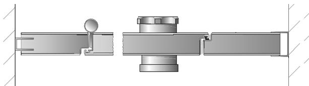
2 Vue en coupe: paroi frontale avec poignée de porte à une main et charnière anti-pinçe doigts en aluminium (en option)
